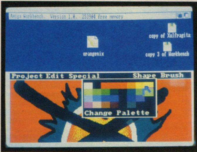
Durch Druck auf die rechte Maustaste wechselt die Anzeige in der oberen Fensterkante von »Orangenix« in verschiedene Menümöglichkeiten. Auf eine wurde der Mauszeiger bewegt, dadurch sprang eine Jalousie mit mehreren Auswahlpunkten (hier Zeichenfarben) heraus.
